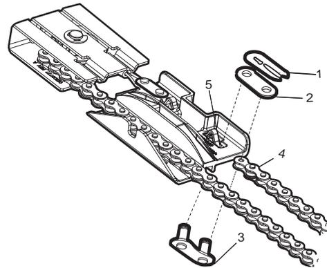
**7 INSERT TROLLEY & IDLER PULLEY BRACKET INTO RAIL**
